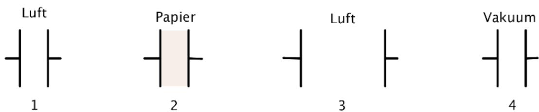
Auf den vier Kondensatoren befindet sich jeweils die gleiche Ladung  $Q$ . Vergleiche die Spannungen der vier Kondensatoren und begründe deine Angaben. Die Zeichnungen sind Maßstabsgetreu.
